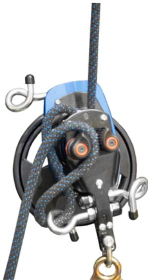
2.- Puede bloquear el dispositivo después de detenerse haciendo pasar la cuerda fuera del dispositivo haciendo un giro en U hacia el cáncamo y de regreso a través de abrazadera de bloqueo de la cuerda como se muestra (tome el volante mientras hace eso)
